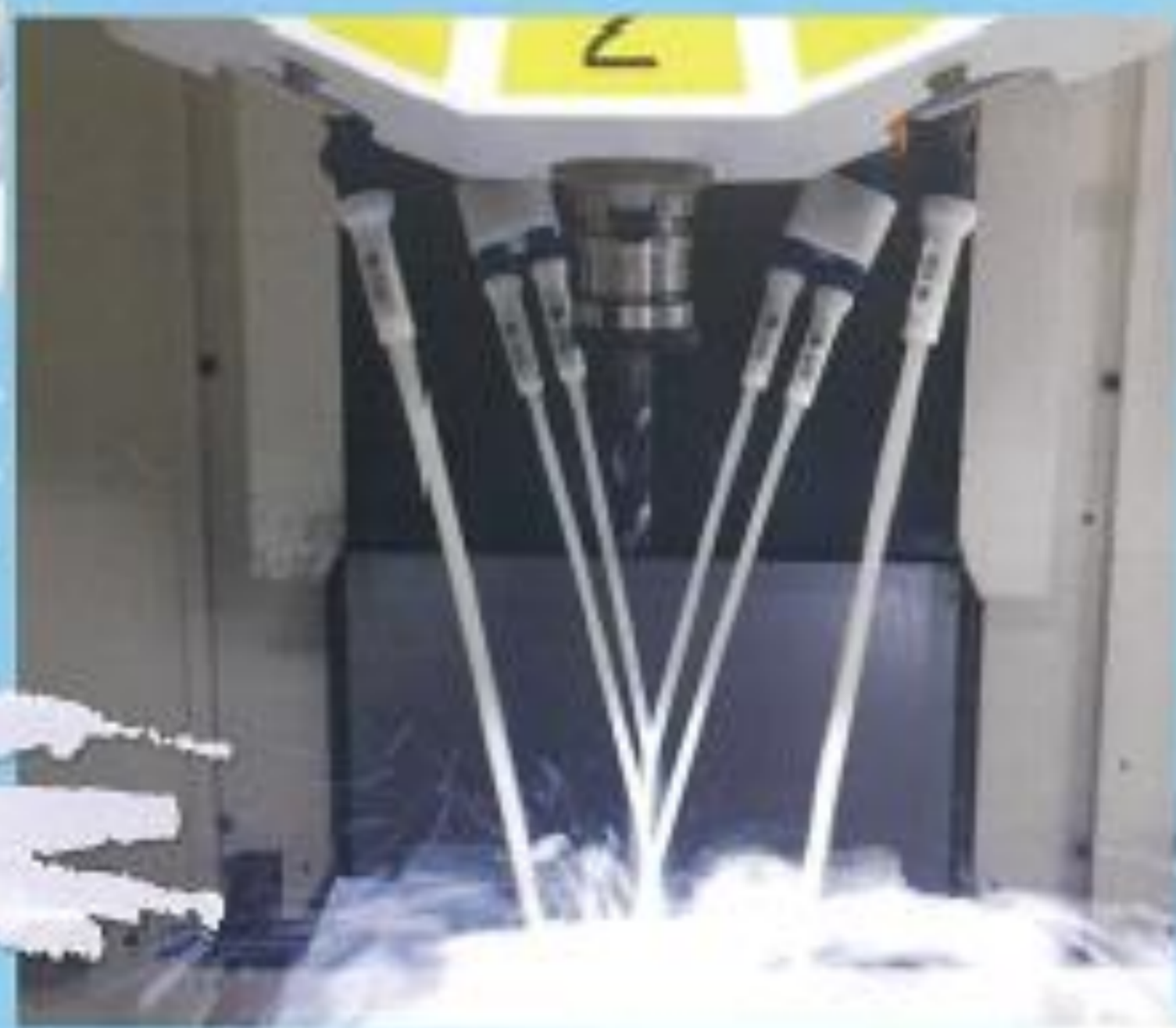
整流ノズルがワークを捉えます
