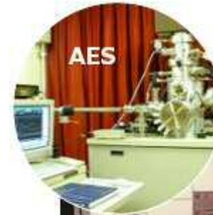
・材料の最表面(原子数層)の状態を把握、表面汚染や酸化などの要因を原子・分子レベルで究明します。
