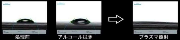
プラズマ照射による親水性向上効果により、塗装、メッキ、接着、吸水性素材等の品質向上が期待できます。
