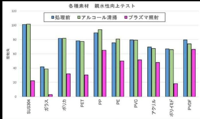
素材としての撥水性が高く、水や洗剤、アルコール等で洗浄しても変化の少ない素材、洗浄の困難な素材に対して、プラズマを照射することで、親水性を持たせることが期待できます。（\*素材により、効果は異なります）
