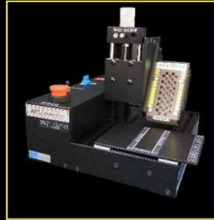
簡易卓上テスト機 HPJ-DESKTOP (照射幅25mm)
