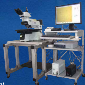
半導体測定装置 Semiconductor inspection system
