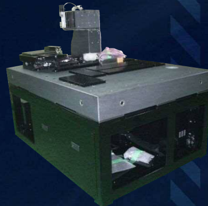
レーザーマーカ用 精密 XYZ ステージ XYZ axis stages for laser markers
