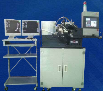
注射針検査装置 Injection needle inspection system
