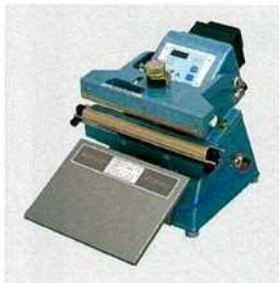
インパルスシーラー 瞬間的に加熱圧着するタイプ。 上下両面加熱式が望ましい。
