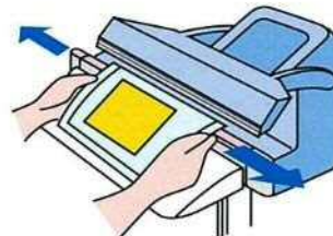
●シール部にシフができないよう、袋の両端を引っ張ります。
