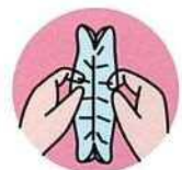
●接着状態をチェック(冷却後、シール部を左右に引っ張ってみる。剥がれれば加熱不足)
